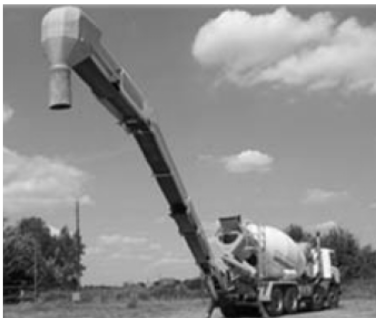
نوار نقاله متحرک نصب شده روی یک تراک میکسر
