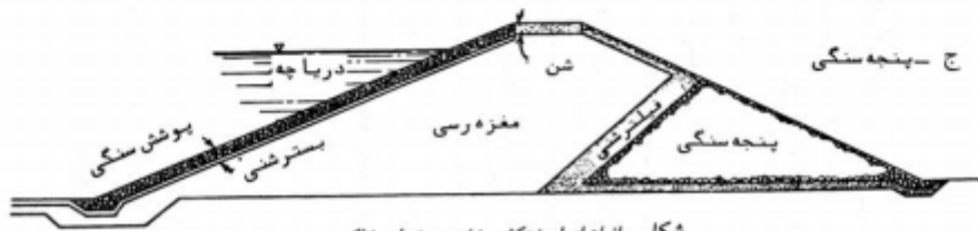
شکل - انواع اصلی زهکشی بدنه در سدهای خاکی
