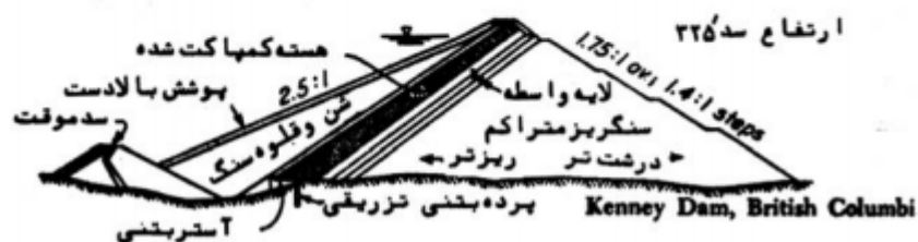
ب - با پوشش مخفی (مغزه مایل) در بالادست
