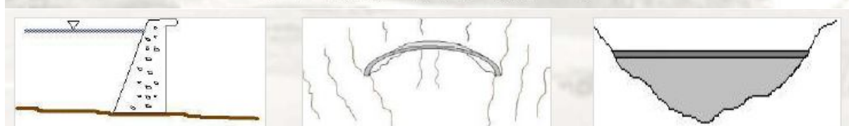
شکل ۸: نما، پلان و مقطع عرضی سدهای بتنی قوسی
